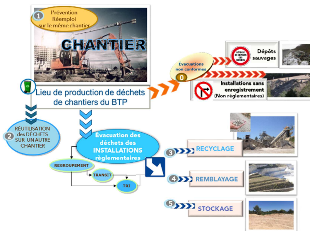
Figure 54 : Schéma général des flux de déchets inertes du BTP, issus de chantiers et leurs filières de traitement
