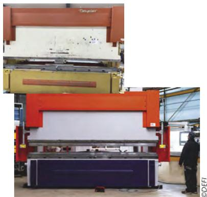
Machine avant et après rétrofit
