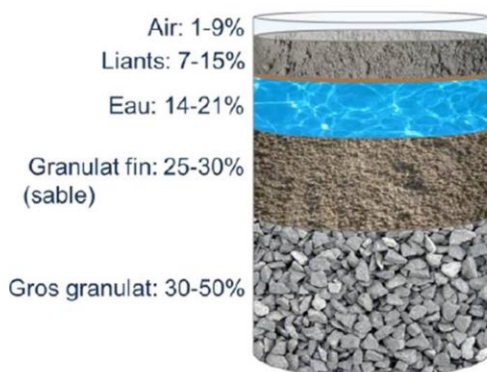
1 m3 de béton
