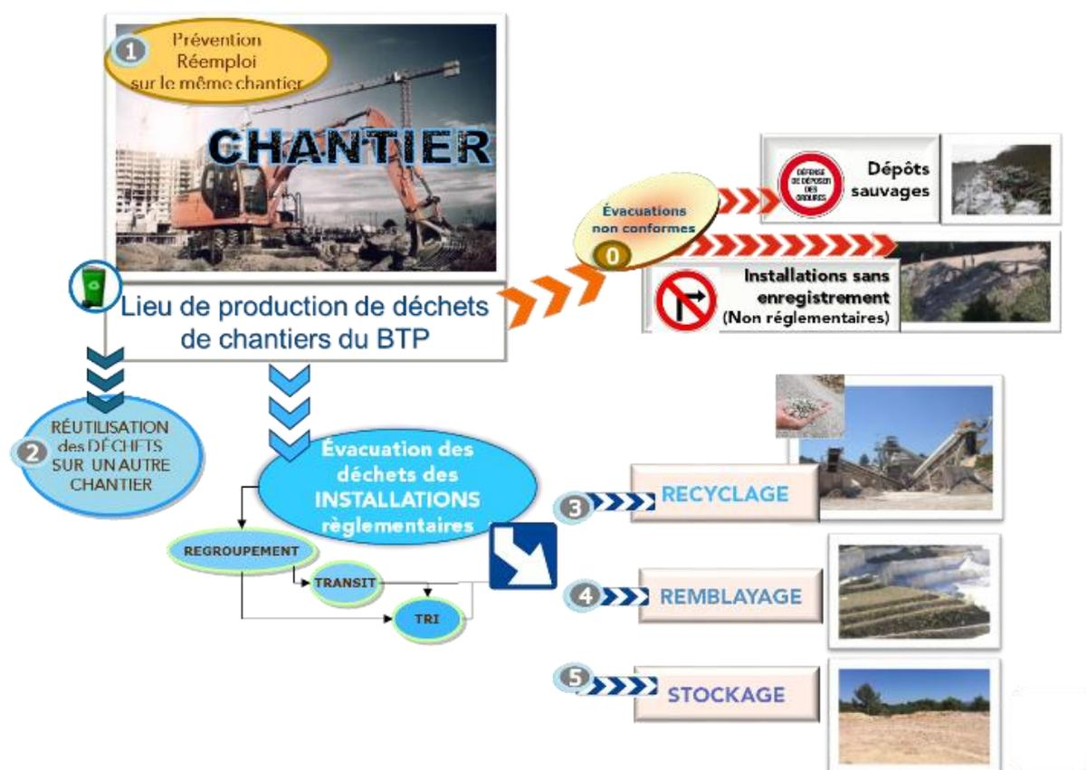
Figure 58 : Schéma général des flux de déchets inertes du BTP, issus de chantiers et leurs filières de traitement
