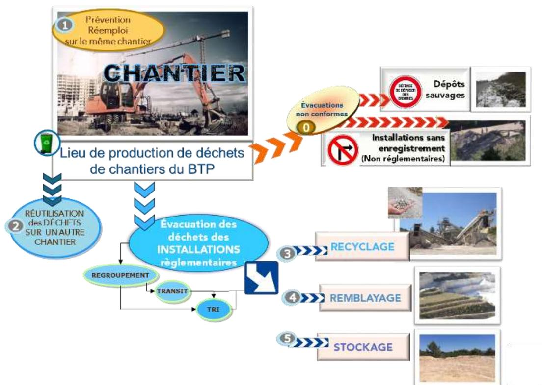
Figure 54 : Schéma général des flux de déchets inertes du BTP, issus de chantiers et leurs filières de traitement
